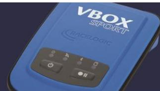
O VBOX Sport é à prova d'água, recarregável e um aquisitor de dados com um sensor de GPS, desenvolvido primeiramente para avaliar o desempenho do veículo ou do tempo da volta. Ele pode ser usado sozinho ou pode ser conectado com um dispositivo iOS via Bluetooth para visualizar os resultados no mesmo momento usando o aplicativo gratuito fornecido pela Racelogic.
