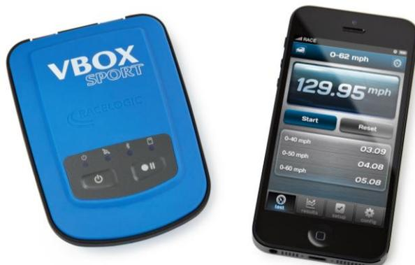
Данный прибор очень легкий, эргономичен, с возможностью подключения внешней антенны, что делает его применимым для мотоциклов и велосипедов.
