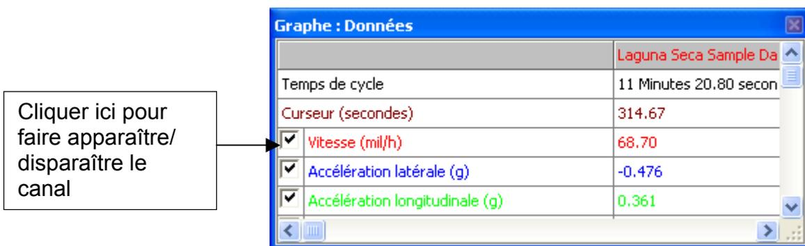
PerformanceTools ajustera automatiquement le canal à ses valeurs maximum et minimum et l'affichera dans la fenêtre du graphe. Le canal activé sera alors en surbrillance dans sa couleur d'affichage.
